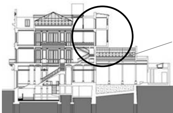
Fig. 24 y 25 – Corte transversal y vista de la descarga de los dos pisos sobre la claraboya
