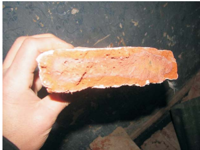
CORTE DE MAMPUESTO - COSIMIENTO
